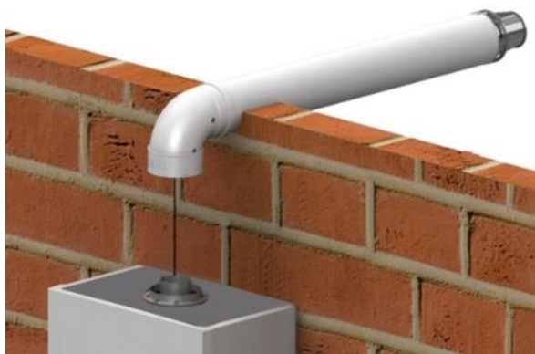
Рисунок. 5 Схема присоединения коаксиального дымохода Ø60/Ø100 (мм)
