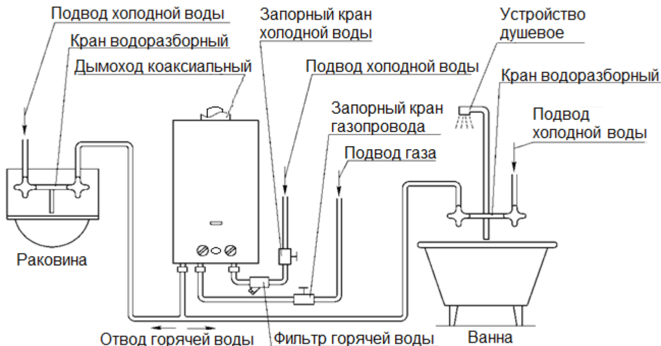
Рисунок 4. Схема установки аппарата
